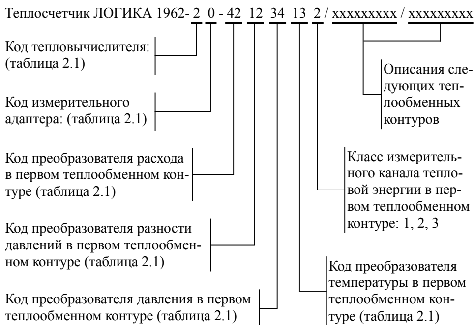
Рисунок 2.1 – Структура обозначения исполнений теплосчетчиков
