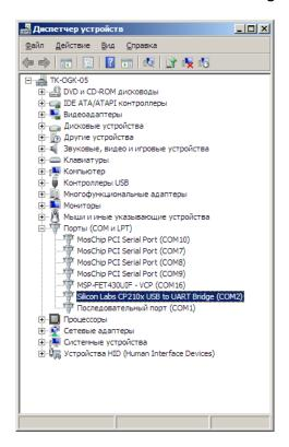
d. Чтобы изменить номер COM-порта, на котором определилось устройство, зайдите в **«Свойства»** Silicon Labs CP210x USB to UART Bridge (правый щелчок мышки -> Свойства)
